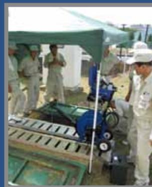
設置後の操作はコントロールユニットから簡単に操作可能。 荷台に搭載した状態でも簡単に調査・撮影が可能です。電源は直接コンセント (AC100V) に差し込み、電源供給が可能です。
